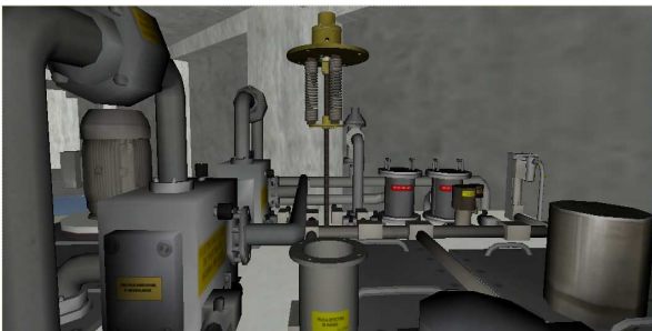
Fig. 6. Retornando com a válvula detectora para a base no regulador de velocidade
