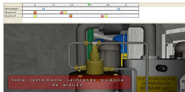
Fig. 4. Desconexão das tubulações da válvula
