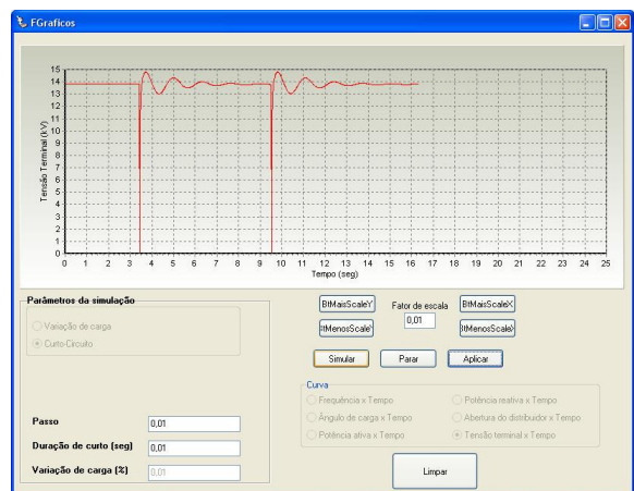
Figura 9. Variação da tensão terminal no gerador.
