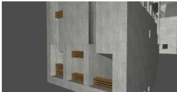
Figura 9 – Colocação de Stop-Logs da Jusante
